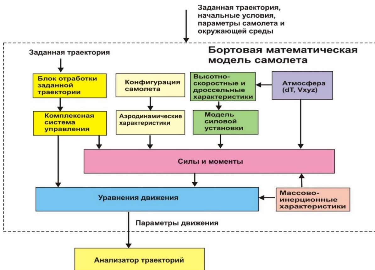
Рис.2. Структура бортовой математической модели самолета
