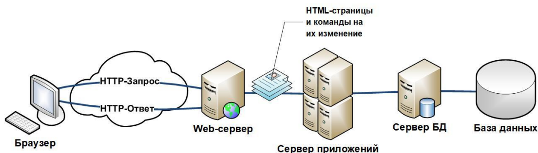
Рис. 7. Схема информационной системы с клиентами на основе web-браузеров
