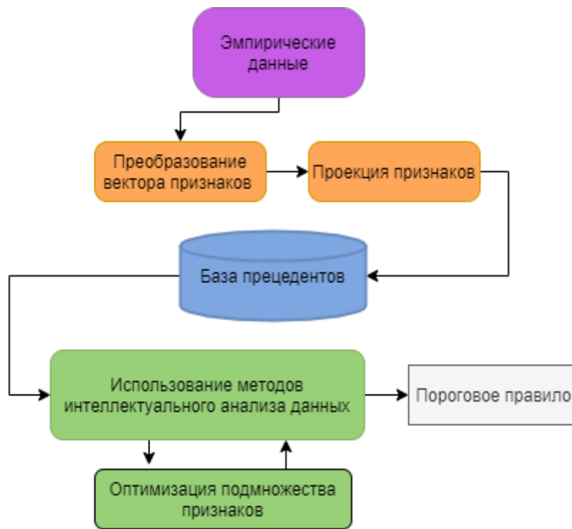
Рис. 1. Схема анализа данных в задаче диагностики электродвигателя
