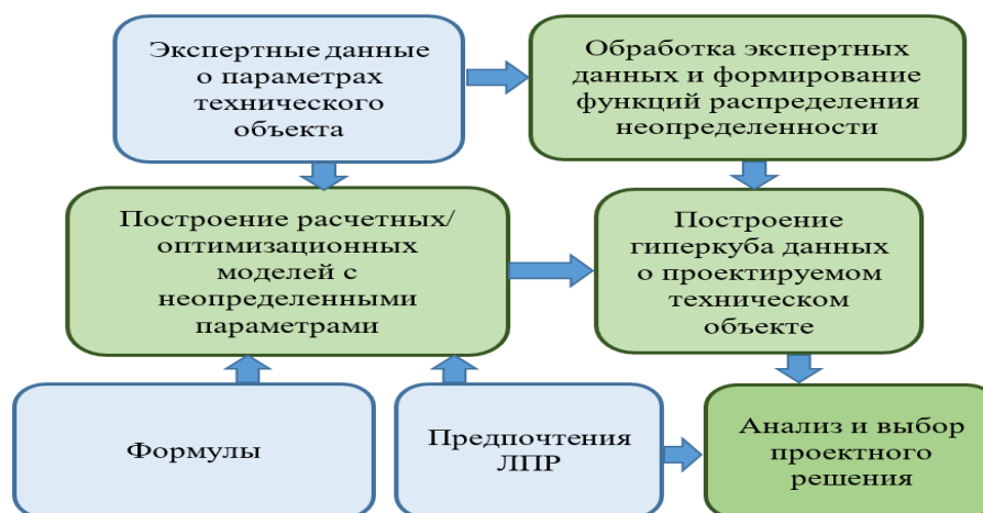
Рис. 1. Схема многовариантного моделирования при предварительном проектировании технических объектов в условиях параметрической неопределенности
