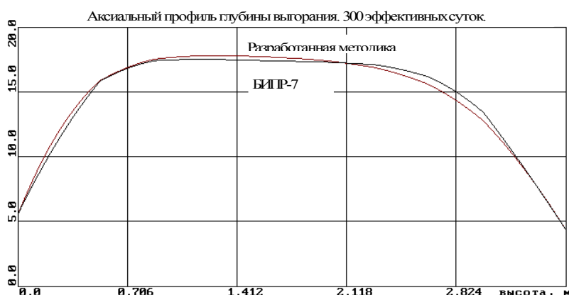
Рис. 7. Аксиальный профиль глубины выгорания
