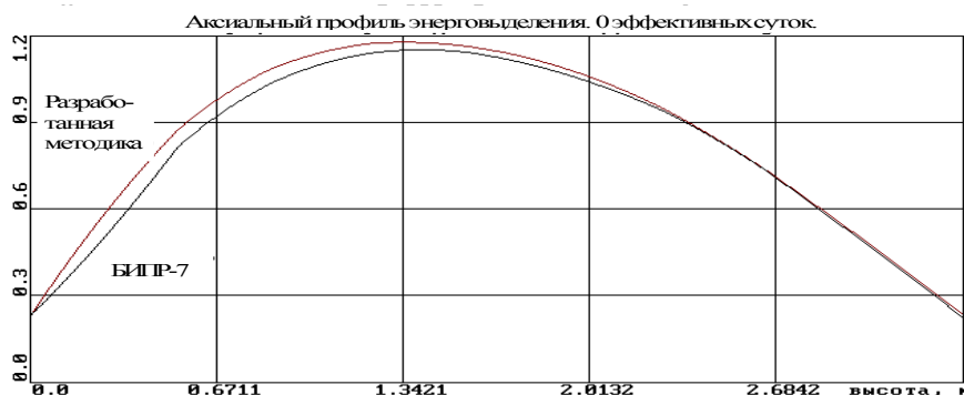
Рис. 3. Аксиальный профиль энерговыделения. Начало кампании.
