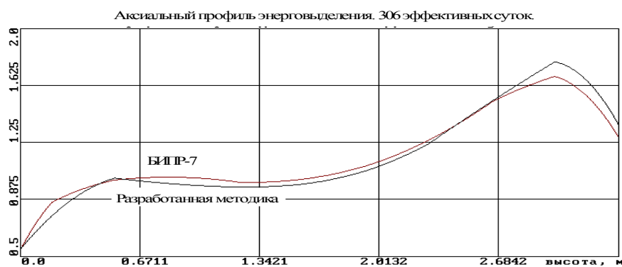
Рис. 5. Аксиальный профиль энерговыделения. 306 эффективных суток
