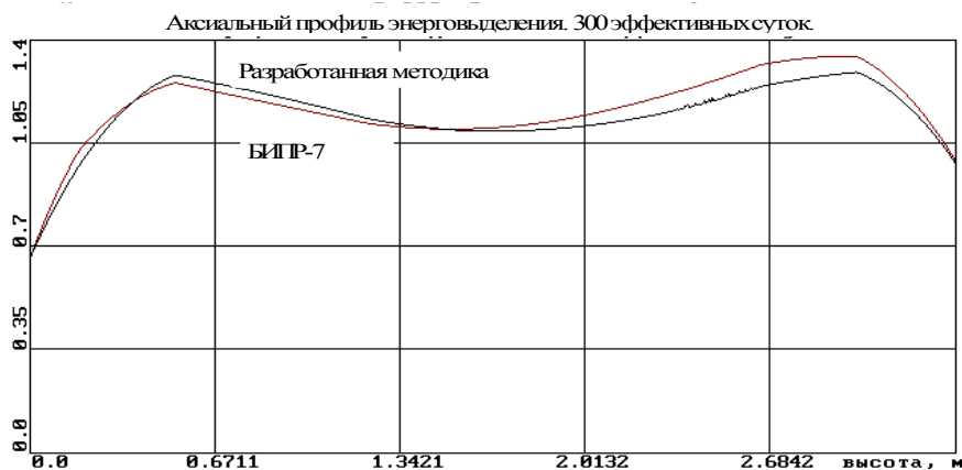
Рис. 4. Аксиальный профиль энерговыделения. 300 эффективных суток
